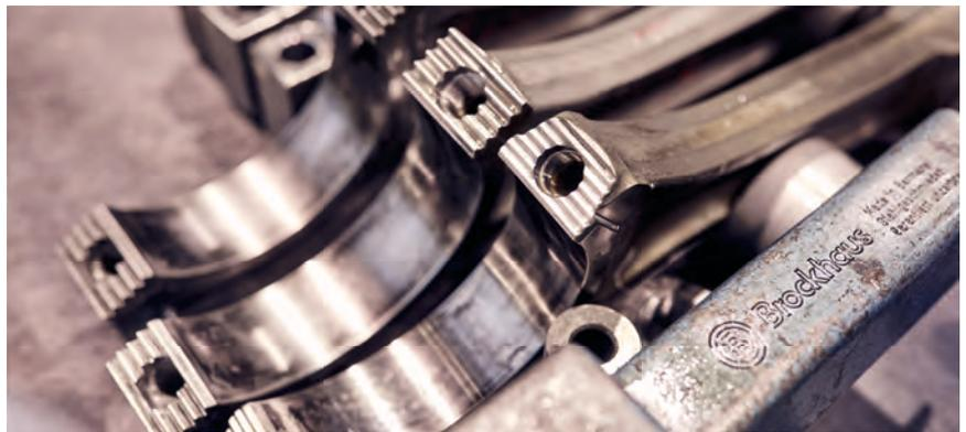
schleifen wir die Verzahnung neu ein. Im Anschluss werden die Lagerflächen überarbeitet und feingeschliffen. Damit ist Pleuelstange fast „wie neu“ und einer erneuten Verwendung im Motor steht nichts mehr im Wege.
